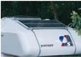
Solaranlage, bestehend aus einem 75-W-Modul, Ladestromregler
