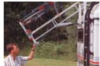
Fahrradträger klappbar oder festmontiert für 2 Fahrräder
