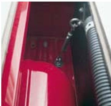
Die Kabine wird an vier Halteteilen mit Spannsitz oder Schraubgewinde auf der Ladefläche des Pickups befestigt
