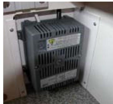
In Serienausstattung enthalten: AGM-Batterie 95 Ah mit Trennrelais und automatischem Ladegerät
